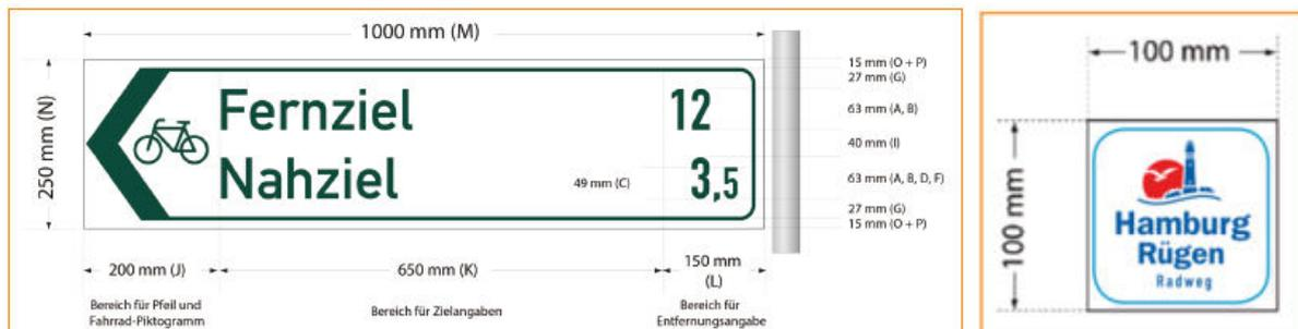
**Abbildung 2:** Gestaltung und Bemaßung von Zielwegweisern, Routenlogo des Radfernwegs HH -RÜG
